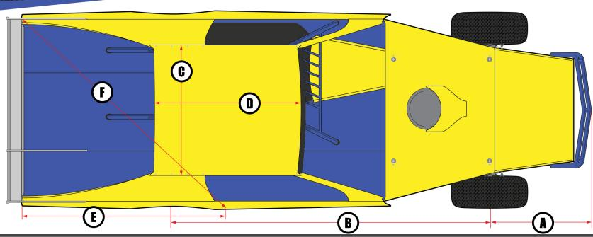
CENTER OF FRONT WHEEL TO FRONT EDGE OF FRONT BUMPER: 42" MAX
